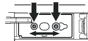
**22.** Uvolnit šrouby a úhelník závěsu přesunout doprava nebo doléva. Utáhnout šrouby.
