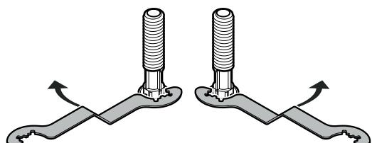
Točit klíčem ve směru hodinových ručiček ke zvednutí spotřebiče, točit klíčem proti směru hodinových ručiček ke spuštění spotřebiče.
