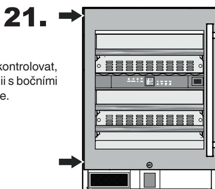
**21.** Zavřít dveře a zkонтролovat, jsou-li ve stejné linii s bočními stěnami spotřebiče.
