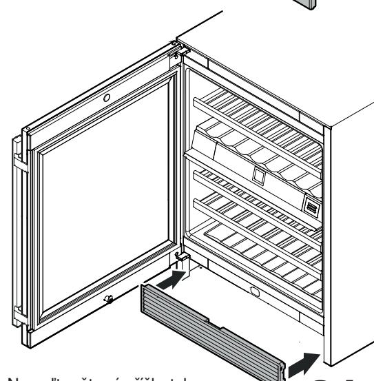
**24.** Nasadte větrací mřížku tak, aby zaskočila do provozní polohy.
