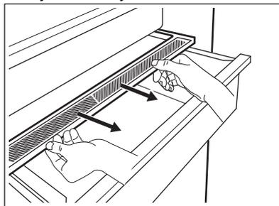
2. Pokud potřebujete vyměnit bílou membránu zařízení, uchopte zařízení uprostřed a zatažením za kryt oddělte membránu od krytu.
