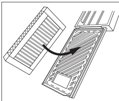
3. Při zavírání plastového krytu přidržte filtr stisknutý, dokud neuslyšíte cvaknutí.
