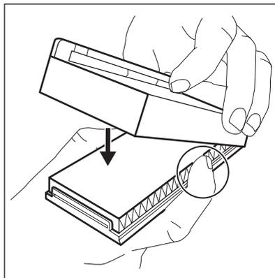
4. Vyberte hornú sklenenú poličku z chladiaceho priestoru. Zasuňte plastový kryt so vzduchovým filtrom na ľavú stranu sklenenej poličky.
