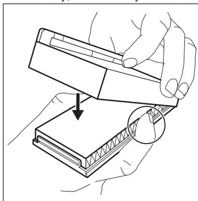
4. Vyjměte horní skleněnou polici z chladicího oddílu. Nasuňte plastový kryt tak, aby se vzduchový filtr nacházel na levé straně skleněné police.
