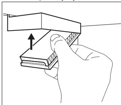
5. Po výměně filtru vypněte výstrahu stisknutím tlačítka Filter Reset výstrahy na ovládacím panelu.
